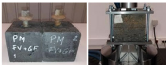
Figura 1 e Figura 2 - ensaio de arrancamento bucha/tirafundo
