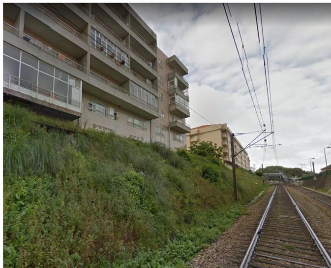
*Figura 122. Edifício próximo da linha, na zona de Coimbrões, ilustrando constrangimentos em termos de ações de minimização de ruído ferroviário, devido ao grande desenvolvimento vertical do edifício (fonte: google maps).*
