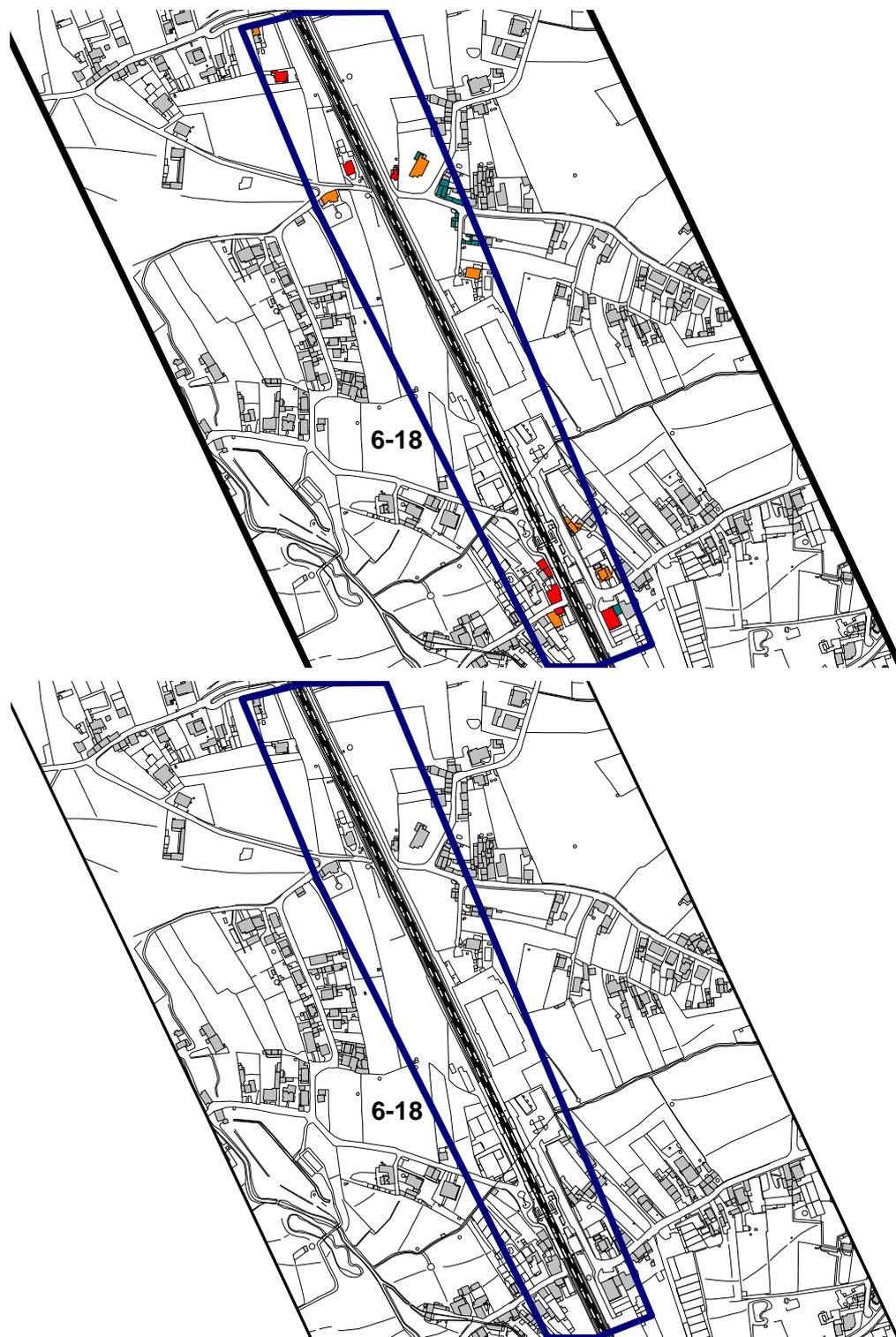
Figura 255. Exposição do edificado ao ruído – Topo: situação existente; Baixo: situação futura – Zona 6-18 (Avanca).
