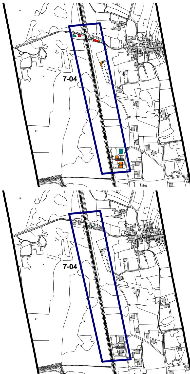
Figura 272. Exposição do edificado ao ruído – Topo: situação existente; Baixo: situação futura – Zona 7-04 (Sisto).
