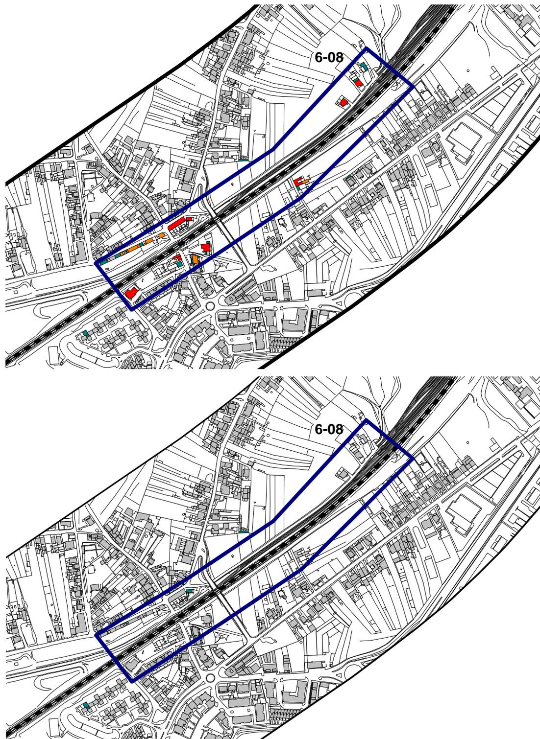
Figura 244. Exposição do edificado ao ruído – Topo: situação existente; Baixo: situação futura – Zona 6-08 (Olho d'Água).
