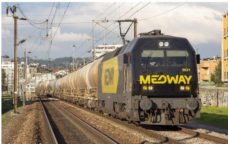
*Figura 13. Comboio de mercadorias do operador Medway, composto por locomotiva 5600 e vagões para cimento.*
