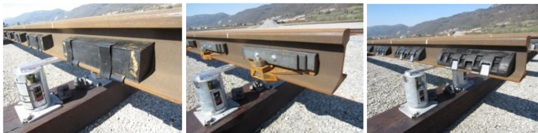
Figura 17. Atenuadores sintonizados de carril (TRD); esq. TATA/Corus, centro Schrey & Veit, direita STRAILastic_A.
